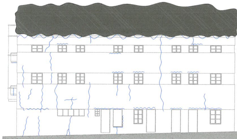
Figura 8 - Representação esquemática da localização da fendilhação existente no alçado "sul" (sem escala)
