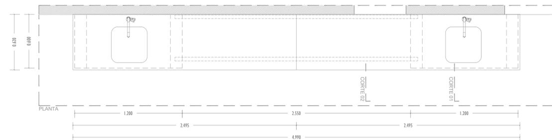
PERFIL METÁLICO DE APOIO DO TAMPO
