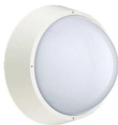
Luminária saliente circular de cor branca (WH) para parede ou tetos, com tecnologia LED para aplicação interior e exterior (IP65-IK10). Difusor em policarbonato opalino. Fonte de luz: Leds de alta potência, temperatura de cor 3000K ou 4000K, restituição cromática >80, fluxo do sistema 1600lm, consumo do sistema 24W, eficácia do sistema (67lm/W), vida 50000h@L70, regulação e controlo PSR.
